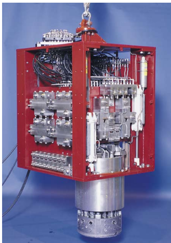
شکل ۲- محفظه کنترل زیر دریایی (Modular Control Pod)
